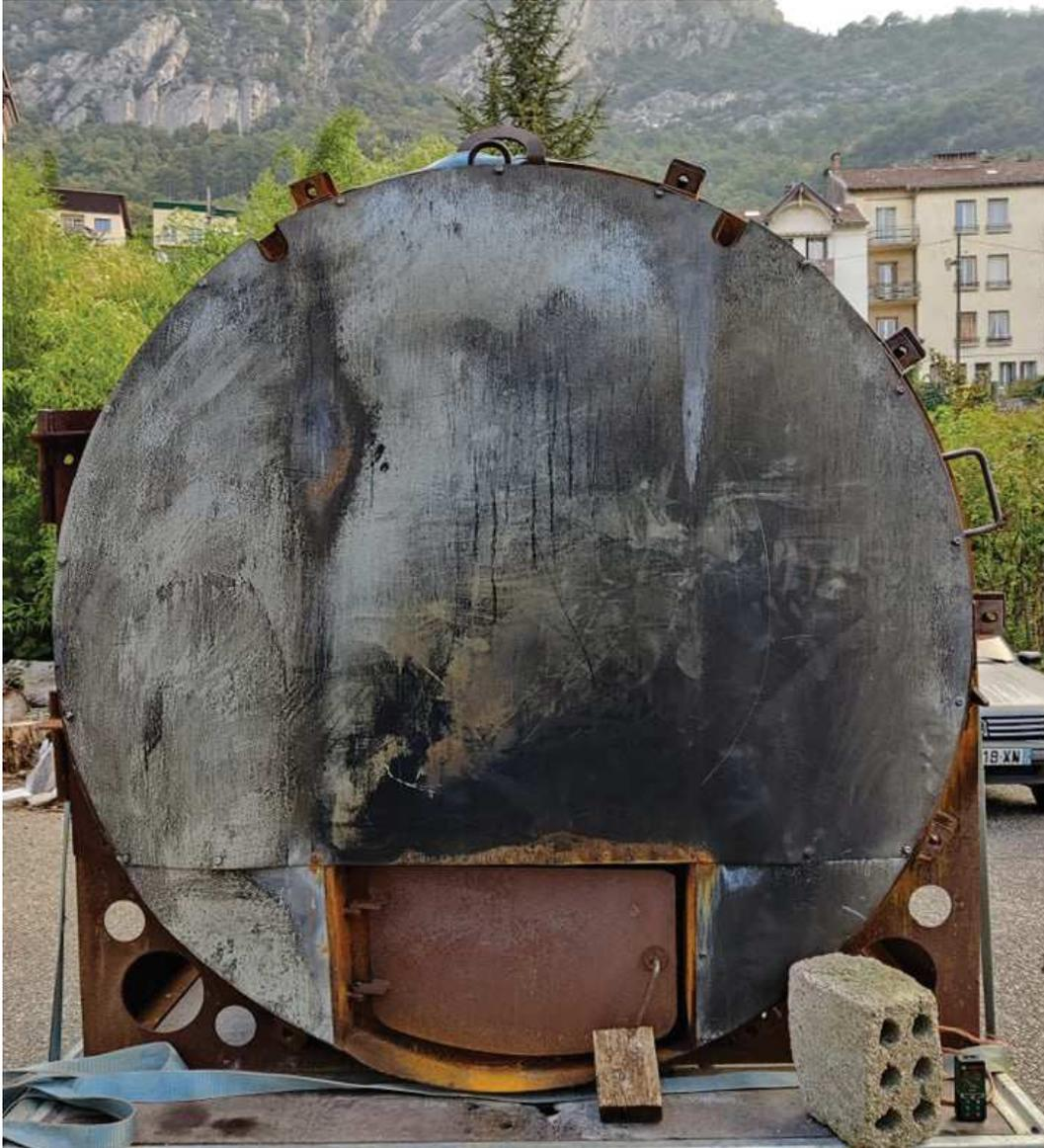
*Photo du four Exeter Retort, toutes portes fermées. La trappe du bas permet de contrôler l'arrivée d'air, et d'alimenter en bois le foyer de combustion au démarrage.*
