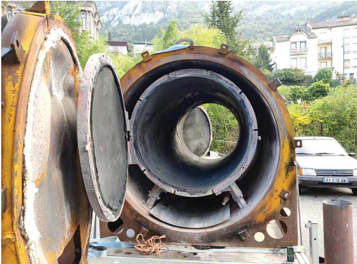
*Photo du four Exeter Retort, dont les portes de la chambre de pyrolyse (à l'intérieur) et de combustion sont ouvertes. Le feu permettant la montée en température est réalisé en dessous de la chambre de pyrolyse*
