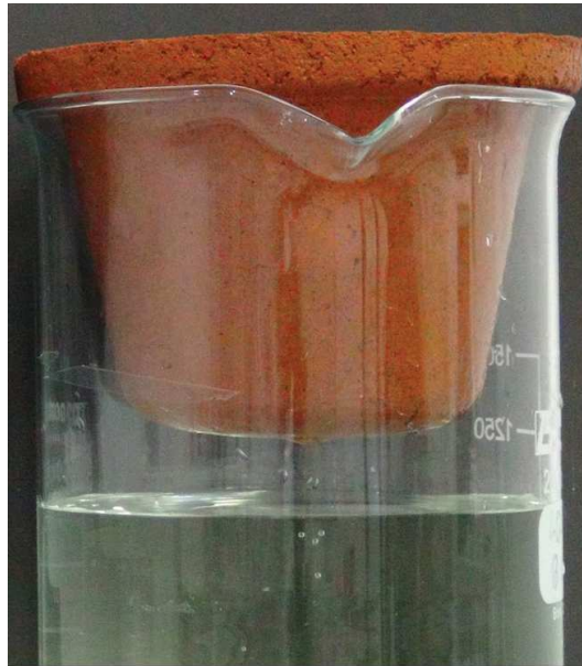
Reproduction d'un filtre à argile de type Filtron
